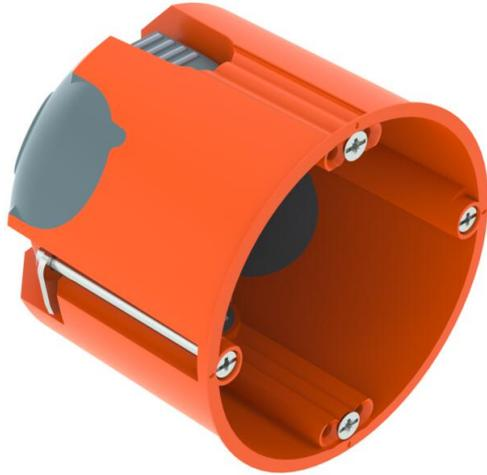
Scatola apparecchi per intercapedini con ingressi a membrana ermetici, per l'impiego in intercapedini con una profondità di installazione di almeno 61 mm e uno spessore pannelli di 5 - 40 mm.
