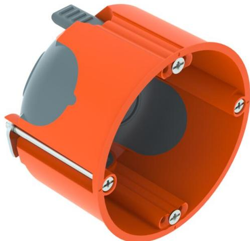
Scatola apparecchi per intercapedini con ingressi a membrana ermetici, per l'impiego in intercapedini con una profondità di installazione di almeno 47 mm e uno spessore pannelli di 5 - 40 mm.
