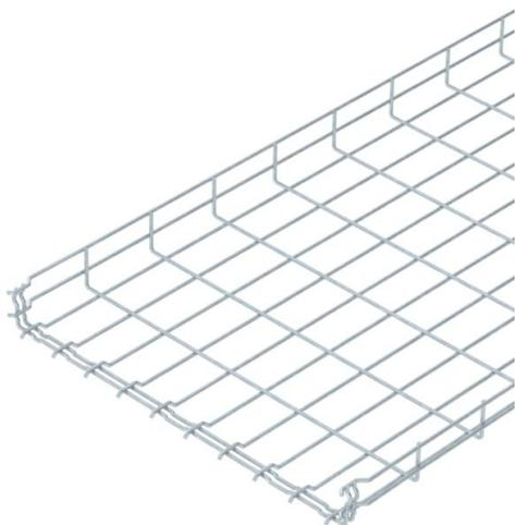
Passerella grigliata ad innesto rapido, con bordo di altezza pari a 55 mm. Per la passerella grigliata non sono necessari ulteriori componenti di collegamento, le due estremità vengono semplicemente inserite l'una nell'altra. La larghezza della maglia è di 50 x 100 mm (eccezione GRM 55/50 = 20 x 100 mm). Schermatura elettromagnetica senza coperchio 15 dB, con coperchio 25 dB.
