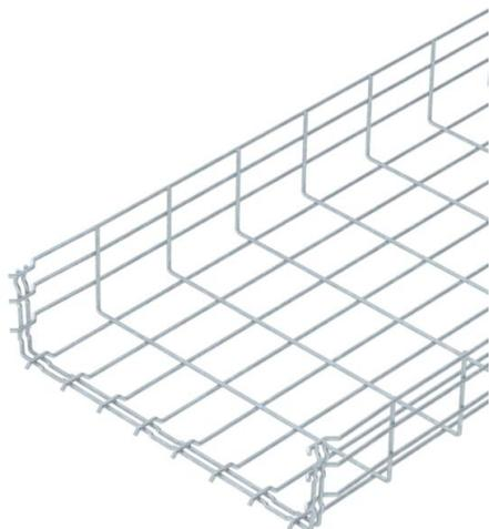
Passerella grigliata ad innesto rapido, con bordo di altezza pari a 105 mm. Per la passerella grigliata non sono necessari ulteriori componenti di collegamento, vengono semplicemente inserite l'una nell'altra. La dimensione delle maglie è pari a 50 x 100 mm. Schermatura magnetica senza coperchio 15 dB, con coperchio 25 dB.
