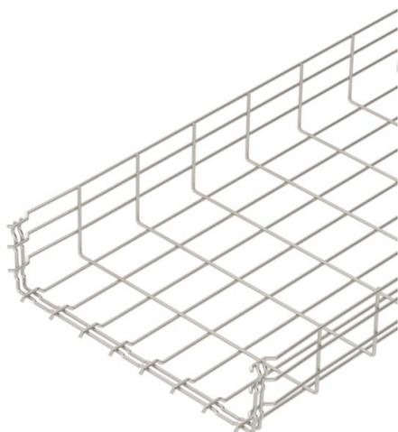
Passerella grigliata ad innesto rapido, con bordo di altezza pari a 105 mm. Per la passerella grigliata non sono necessari ulteriori componenti di collegamento, le due estremità vengono semplicemente inserite l'una nell'altra. La larghezza di maglia è pari a 50 x 100 mm. Schermatura magnetica senza coperchio 15 dB, con coperchio 25 dB.
