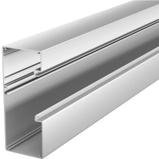
Canale porta apparecchi senza foratura alla base indicato per il montaggio diretto a parete o su mensole. Su richiesta possono essere realizzati anche elementi inferiori e superiori dei canali e coperchi con lunghezze extra, fino a 6000 mm, e anche altri colori RAL. Le superfici esterne dei canali porta apparecchi sono laminate.
