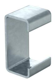
Distanziatore per l'impiego nel supporto a soffitto tipo KU 5 V. Il distanziatore viene sempre applicato per un aumento della stabilità, per fare in modo che durante il serraggio della mensola con viti a testa esagonale il profilato non si deformi.
