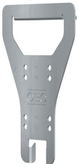
Utilizzando il sollevatore, i coperchi scanalati installati con le clip di fissaggio possono essere smontati rapidamente e semplicemente. Posizionare il sollevatore del coperchio sulle clip di fissaggio e rimuovere uniformemente il coperchio. Ripetere l'operazione in senso longitudinale fino a rimuovere l'intero coperchio.
