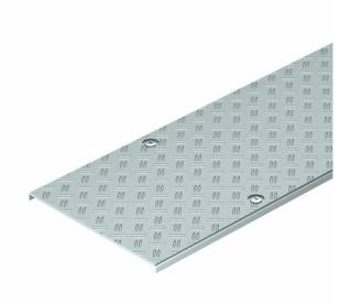
Coperchio passerella portacavi per sistemi calpestabili BKRS. Copertura della base zincata con uno spessore del materiale di 2 mm con una piastra di controllo in alluminio rivettata aggiuntiva come motivo a duetto con uno spessore del materiale di 4 mm, antiscivolo e antiscivolo. Chiusura a un quarto di giro con una distanza di un quarto di giro di 500 mm.
