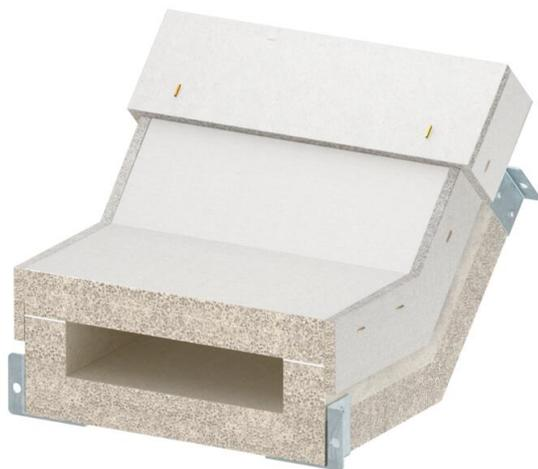
Curva verticale ascendente per canale antincendio PYROLINE® Con S, tipo BSKH09-K0521 in calcestruzzo leggero con fibra di vetro resistente all'acqua e al gelo per realizzare variazioni di direzione verticali (45°) nello sviluppo del canale. I materiali di collegamento montati consentono un rapido montaggio dei pezzi del canale sul posto, i coperchi allentati consentono una rapida revisione e disposizione successiva.
