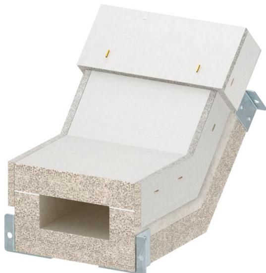
Curva verticale ascendente per canale antincendio PYROLINE® Con S, tipo BSKH09-K0511 in calcestruzzo leggero con fibra di vetro resistente all'acqua e al gelo per realizzare variazioni di direzione verticali (45°) nello sviluppo del canale. I materiali di collegamento montati consentono un rapido montaggio dei pezzi del canale sul posto, i coperchi allentati consentono una rapida revisione e disposizione successiva.
