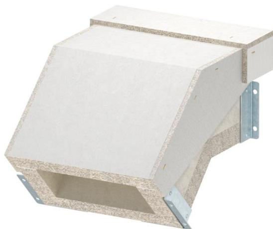
Curva verticale discendente per canale antincendio PYROLINE® Con S, tipo BSKH09-K1021 in calcestruzzo leggero con fibra di vetro resistente all'acqua e al gelo per realizzare variazioni di direzione verticali (45°) nello sviluppo del canale. I materiali di collegamento montati consentono un rapido montaggio dei pezzi del canale sul posto, i coperchi allentati consentono una rapida revisione e disposizione successiva.
