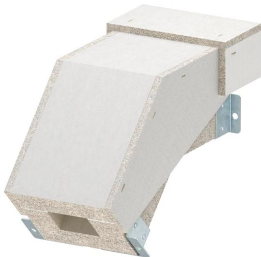
Curva verticale discendente per canale antincendio PYROLINE® Con S, tipo BSKH09-K0506 in calcestruzzo leggero con fibra di vetro resistente all'acqua e al gelo per realizzare variazioni di direzione verticali (45°) nello sviluppo del canale. I materiali di collegamento montati consentono un rapido montaggio dei pezzi del canale sul posto, i coperchi allentati consentono una rapida revisione e disposizione successiva.
