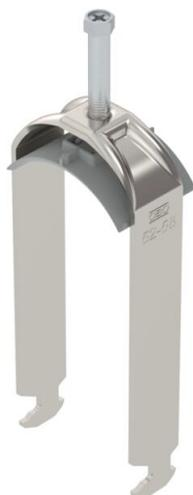
Staffa reggicavo con ancoraggio a testa di martello, coppa in plastica in polipropilene. Per il montaggio verticale e orizzontale di 2 cavi singoli su profilato a C. Per dimensioni scanalatura di 16-17 mm. Con 1 vite a pressione, testa a vite esagonale universale SW10, con fessura e taglio a croce. Per il montaggio in ambienti interni ed esterni. Separazione tra due cavi grazie alla coppa doppia. Si consiglia di utilizzare una controcoppa.
