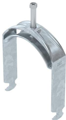
Staffa reggicavo con base a testa di martello, coppa in metallo con bordi arrotondati per la protezione del cavo. Per il montaggio verticale e orizzontale di 1 cavo singolo su profilato a C. Per dimensioni scanalatura di 16-17 mm. Con coppa di pressione, testa a vite esagonale universale SW10, intaglio a croce e a taglio. Per il montaggio in ambiente interno ed esterno. La controcoppa deve essere ordinata separatamente.
