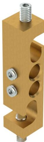
Morsetto di collegamento doppio per l'alloggiamento di 2 cavi conduttori per il collegamento equipotenziale del sistema di canali. Utilizzato come punto nodale per le deviazioni e le derivazioni a croce. Montaggio sul cavo conduttore, al centro della molla di serraggio.
