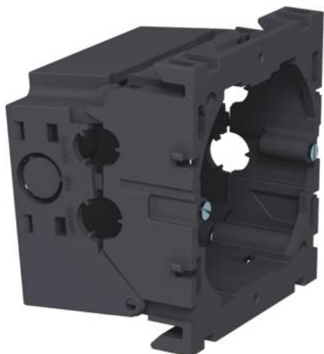
Scatola incasso apparecchi ad aggancio frontale per sistemi di interruttori con elemento inferiore ribaltabile e all'occorrenza rimovibile per rapidi collegamenti di cavi, dotata di aperture di alimentazione per cavi con diametro fino a 14 mm. Versione priva di alogeni. Guida di fissaggio orizzontale 60 mm.
