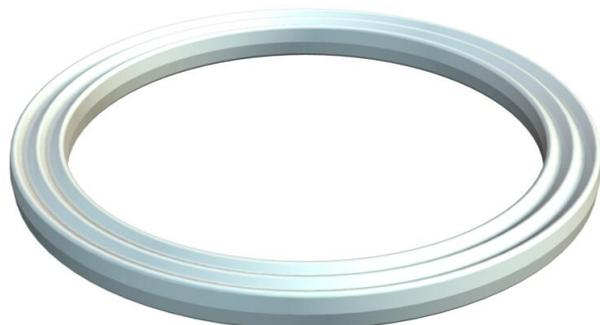
Guarnizione esterna per raccordo filettato simile Parte 9 secondo DIN 46320, tuttavia le dimensioni possono divergere secondo il materiale e la funzione, adatta a tutti i pressacavi in plastica con raccordo filettato Pg secondo DIN 40430. I diametri interni sono posizionati in modo tale che gli anelli di tenuta possano essere preinstallati in modo fisso.
